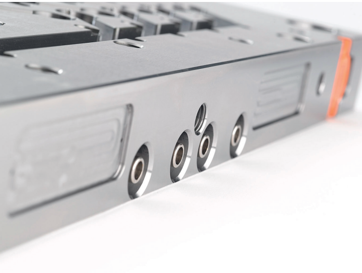
Bild 2: Seitliche Komplettbearbeitung mit Tiefflochbohrungen
