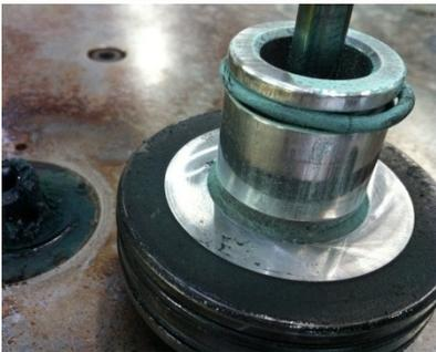
Abbildung 90: Kolbendichtung defekt
