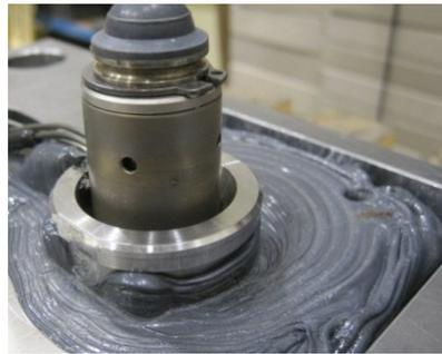
Abbildung 91: Falsche Höhenabstimmung - Heißkanal überspritzt
