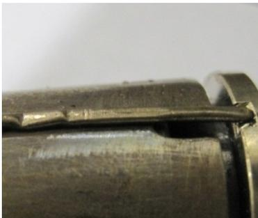
Abbildung 77: defektes / gequetschtes Thermofühler-element
