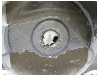
Abbildung 92: Falsche Höhenabstimmung – unzureichende Vorspannung
