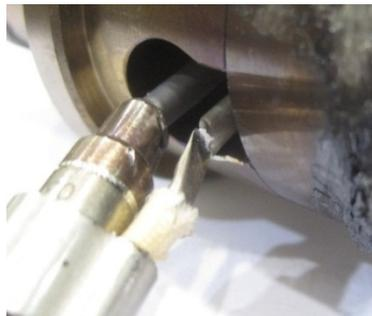
Abbildung 75: defektes / abgetrenntes Thermofühler-element
