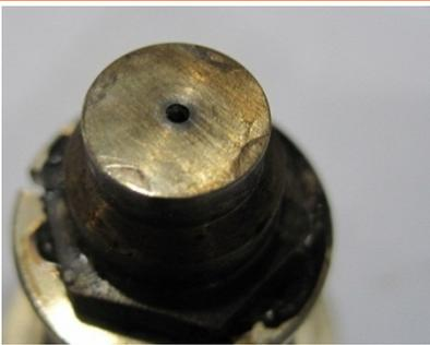
Abbildung 93: Leckage bedingt durch Anlage der Düsenvorkammer
