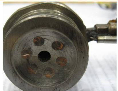
Abbildung 95: beschädigte Dichtfläche am Anlageradius, Leckage möglich
