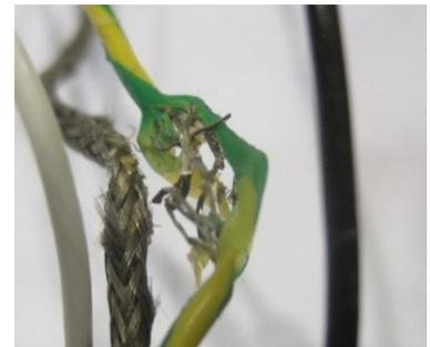
Abbildung 79: defekte Erdungsleitung
