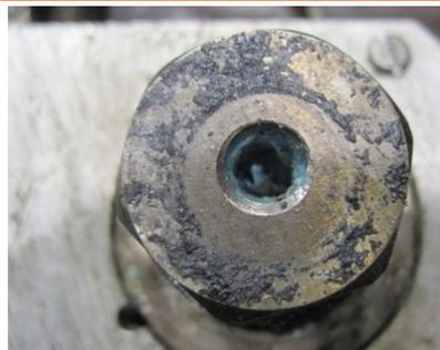
Abbildung 94: Düsenanlageradius fluchtet nicht, Leckage möglich
