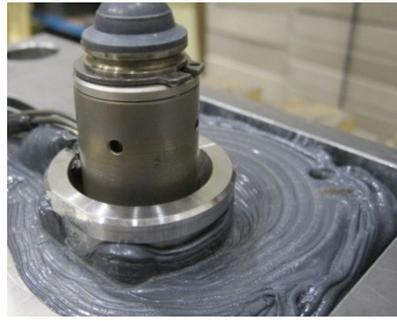
Figura 91: Ajuste de altura incorrecto - canal caliente cubierto de plástico
