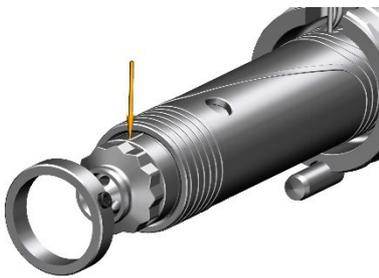
Figura 60: Calentador de eje TC Vario Shot externo
