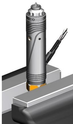
Figura 64: Sujeción del Vario Shot atornillado
