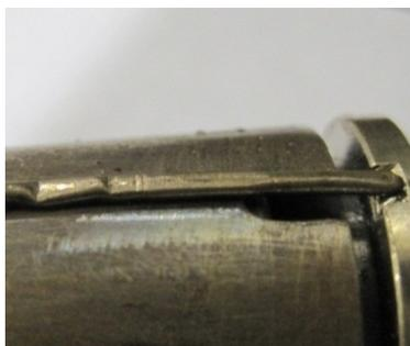
Figura 77: Elemento de termopar defectuoso / comprimido
