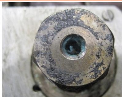
Figura 94: Radio de contacto de la boquilla no alineado, posible fuga
