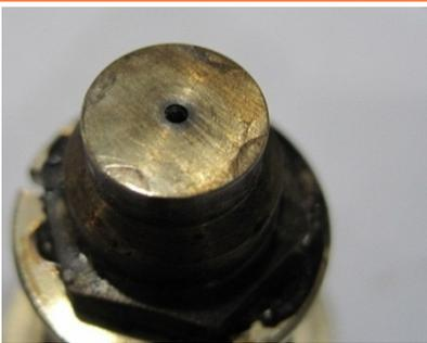
Figura 93: Fuga debido al contacto de la cámara de fusión de la boquilla
