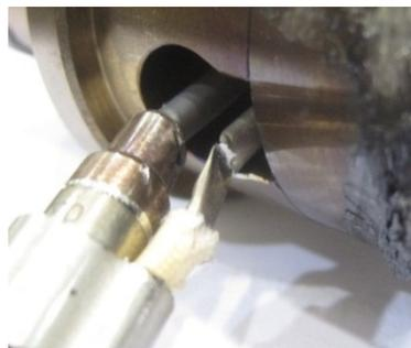
Figura 75: Elemento de termopar defectuoso / cortado
