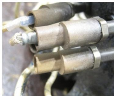
Figura 78: Cables calefactores rotos, radio de curvatura demasiado pequeño
