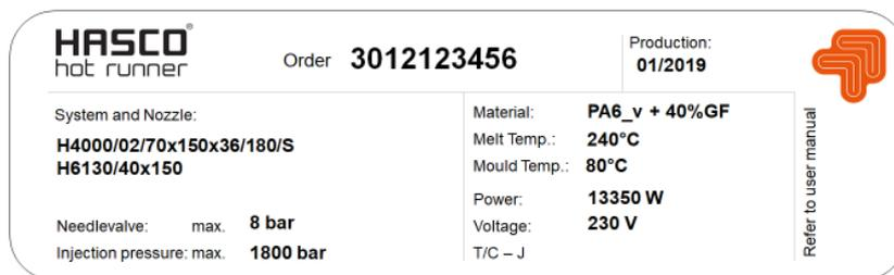
Figura 9: Placa de identificación del canal caliente
