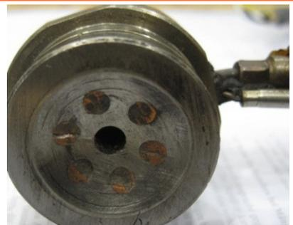
Figura 95: Superficie de sellado dañada en el radio de contacto, posible fuga
