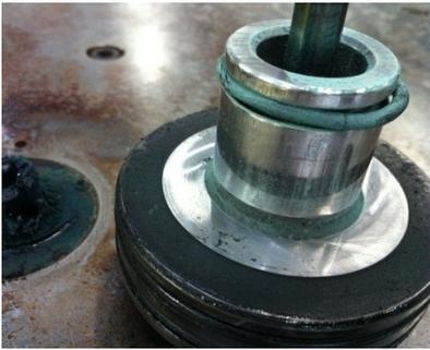
Figura 90: Junta del pistón defectuosa
