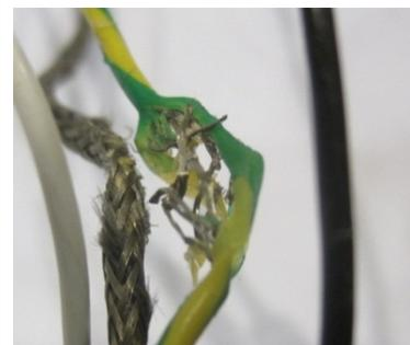
Figura 79: Cable de tierra defectuoso
