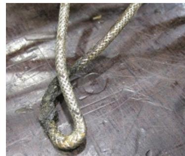
Figura 76: Cable calefactor comprimido
