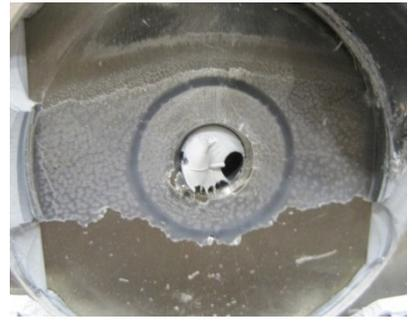
Figura 92: Ajuste de altura incorrecto - precarga insuficiente
