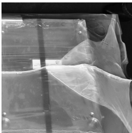
Piastre su pallet con supporto di cartone, fascette di fissaggio e pellicola
