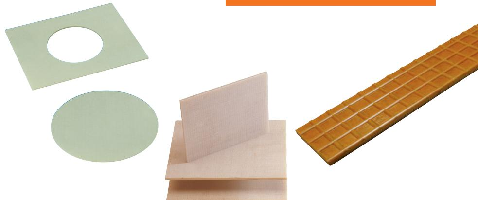
Die HASCO Wärmeisolierplatten verhindern den Wärmeabfluss aus beheizten Spritz- und Presswerkzeugen in die Maschinenaufspannplatten. Sie sind speziell für hochbeanspruchte Werkzeuge entwickelt worden und zeichnen sich durch hohe Druckfestigkeiten auch bei großen thermischen Belastungen aus.
